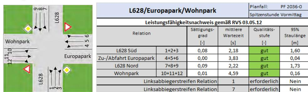
Abbildung 23: Knotenstrom und Leistungsfähigkeitsnachweis gemäß RVS 03.05.12, L628/Europapark/Klöcklweg, Vormittag, PF 2036-0
