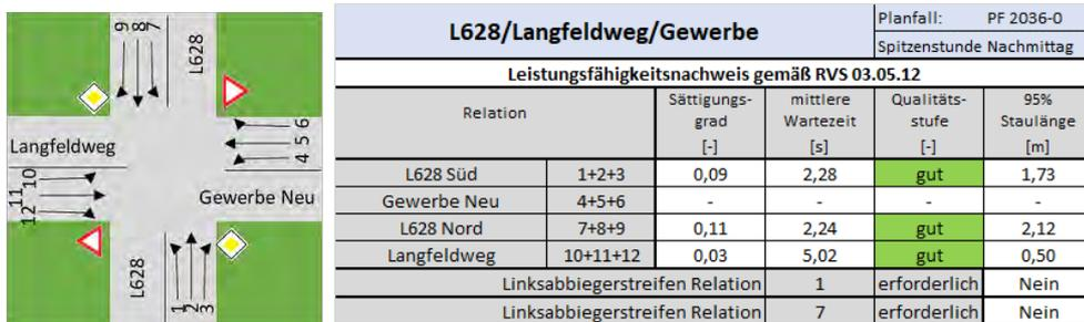
Abbildung 27: Knotenstrom und Leistungsfähigkeitsnachweis gemäß RVS 03.05.12, L628/Langfeldweg, Nachmittag, PF 2036-0
